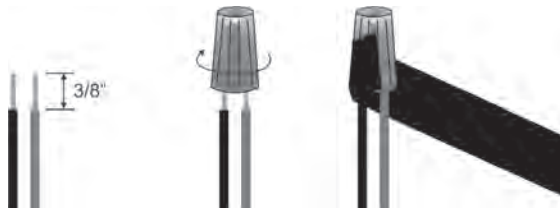
Quite un revestimiento de unos 3/8 de pulgada de los conductores Inserte los cables derechos y luego dóblelos a la derecha Asegure cada conector con cinta eléctrica
