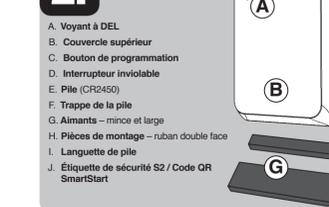
La distance d'écartement entre l'aimant et le capteur déterminant quel aimant doit être utilisé (voir le schéma). Utilisez l'aimant afin qu'il s'aligne avec le bord du capteur. L'aimant étroit présente une distance d'écartement maximale de 1/2 po. L'aimant large présente une distance d'écartement maximale de 1 po.
